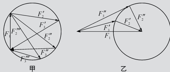
b. 动态平衡时一个力  $F_2$  大小不变、方向改变,另一个力  $F_3$  大小、方向都改变,如图乙所示.
